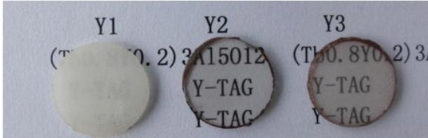
图3 1680°C烧结1 h (Y1)、24 h (Y2)和用两步法(Y3)获得的
