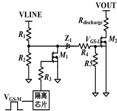
图 9 高可靠漏电钳位保护电路
