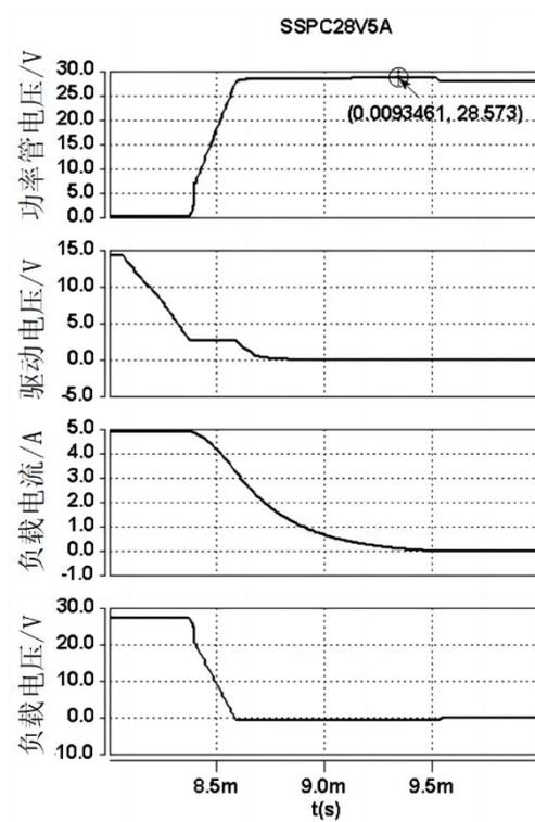
图7 SSPC 关断阻感负载
