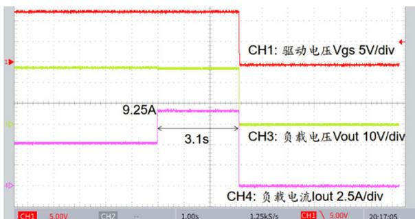
图 16 1.8 倍过载保护实验波形
