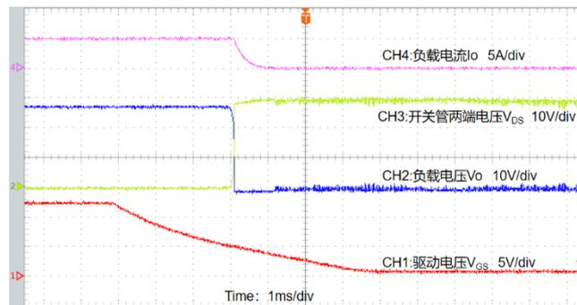
图 13 SSPC 正常关断阻感负载波形
