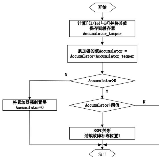
图 11 反时限数字保护流程图
