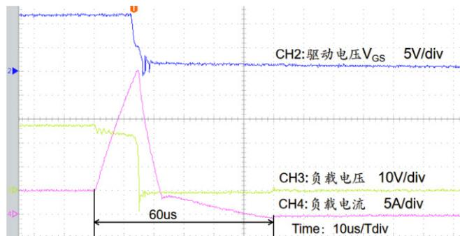
图 14 SSPC 短路保护波形
