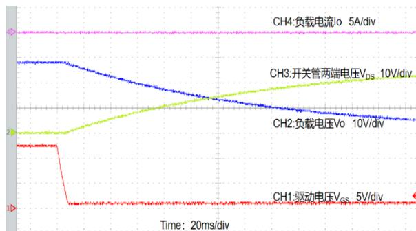
图 15 漏电保护电路工作波形
