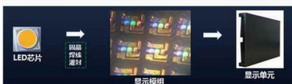
图 5 COB 封装流程图
