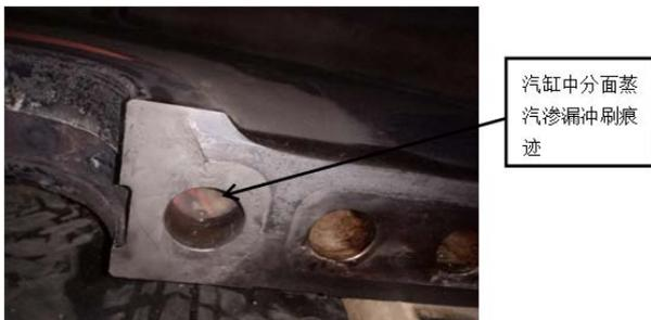
图 2 汽缸中分面局部冲刷
