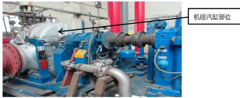
图 1 1#蒸汽透平机组
