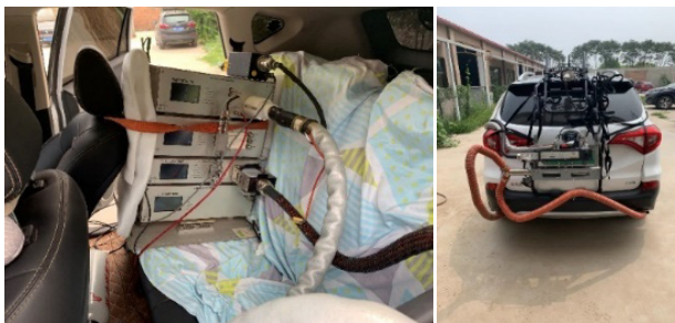
图3 PEMS 实际道路测试图
