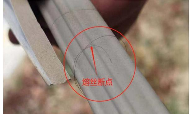
图8 31PT A 相熔断器熔丝断点
