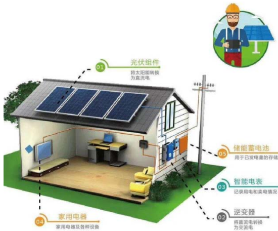
图2 家用光伏系统组成
