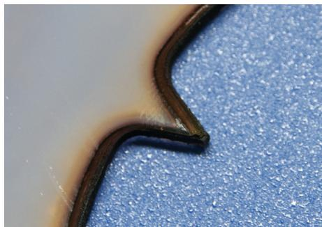
图 10 使用四周刻蚀损伤后的压盘尖角不平
