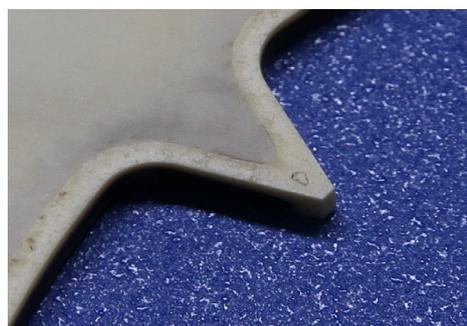
图 11 使用六个月后陶瓷压盘尖角基本没有损伤
