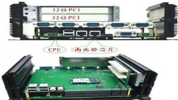
图2 无风扇工控机工业部件
