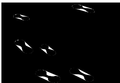
图 12 其中一次采集到的图像未经中值滤波的凸缺陷图形
