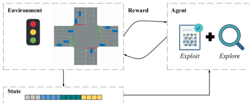
图2 基于强化学习的交通信号控制框架
