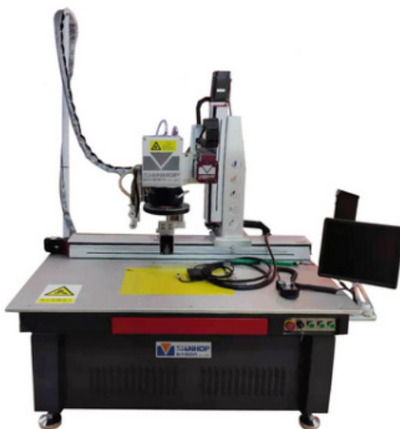
图 1 软包电池模组激光焊接机模型
