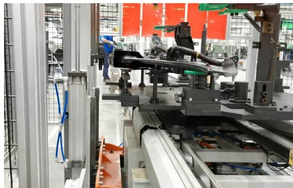
图 2 前悬分装线前横向稳定杆支架与前副车架自动拧紧站
