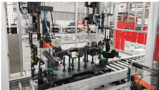
图 1 后角模块总成与后副车架连接的自动拧紧站
