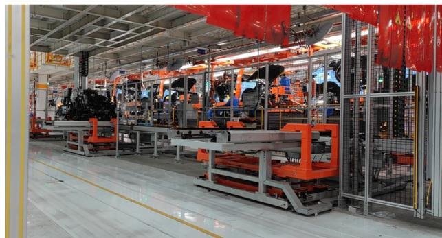
图 3 动力总成带托盘整体转载
