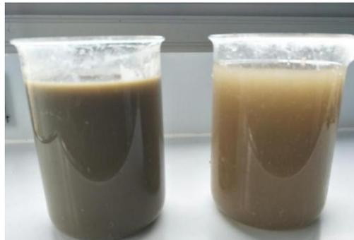
图 7 系统进水浓度对比 (左: 排水 90min; 右: 排水 120min)
