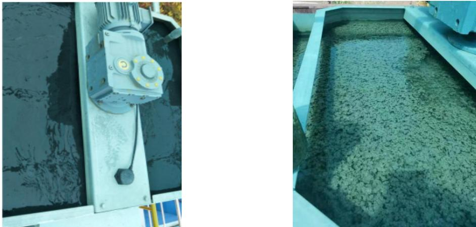
图 8 叠螺机搅拌筒脱水絮凝效果对比图 (左: 效果差; 右: 效果良好)
